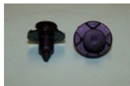
AP0539 QTY:15 Screw Grommet, White. Fiat/Alfa Romeo/Lancia. Toyota / Nissan / Mitsubishi Nissan part no. 01281-00023
